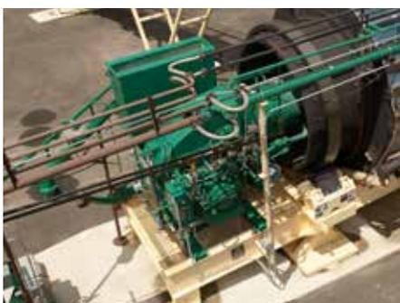
Le Phoenix® Talon utilise beaucoup moins d'énergie électrique que les brûleurs conventionnels grâce à l'entraînement à fréquence variable utilisé pour contrôler la soufflante d'air de combustion et la basse pression du corps du brûleur.
