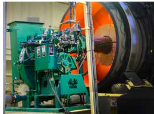
Grâce à une construction simple, le brûleur est facile à entretenir.
